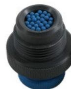
La parte de oro en la célula de cloro se debe cubrir con las perlas de cristal azul para la limpieza continua. Cerciérese de que el electrodo de oro está cubierto con la cantidad correcta de las perlas de cristal azules (1 capa de perlas que cubriendo el electrodo).
