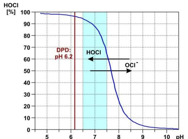
Si se realizan mediciones de control regulares con el método DPD, es importante que la medición DPD se realice siempre a un valor pH de aprox. 6,2. Esto se logra integrando un tampón de pH en los reactivos DPD, de modo que siempre se medirá el cloro activo total, independientemente del valor pH real del vaso.
