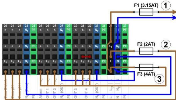
El suministro para el equipo PoolManager® para el relé de alarma y para las funciones adicionales comparten una entrada de red común (L/N). La fase L para el PoolManager® pasa a través del fusible F1. La fase L<sub>F</sub> para el relé de alarma y las funciones adicionales pasa a través del fusible 3. Los conductores neutros N y NF están conectados entre sí internamente.
