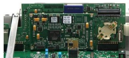
6. Ponga la batería nueva dentro del portabaterías con la cara plana (+) mirando hacia arriba.
