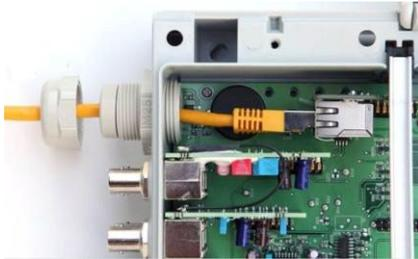
8. Apriete la junta de goma en el racor roscado para cables.
