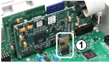
El módulo de configuración está insertado en la base y se puede cambiar o insertar en otro equipo fácilmente.
