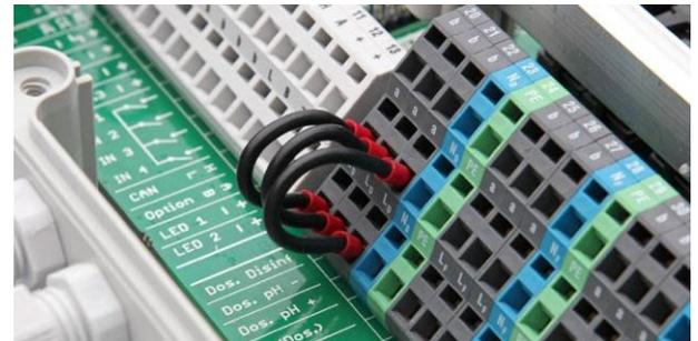
Puentes en el compartimento de terminales de la fase L<sub>D</sub> al contacto central 'a' de las salidas de dosificación.
