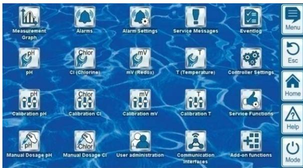
El manejo y la comunicación con el equipo se realizan a través de una gran pantalla táctil TFT en color. Cada una de las funciones que se visualizan en la pantalla se pueden ejecutar simplemente presionando con el dedo en el icono de la pantalla correspondiente. Una señal acústica confirma cada presión que se hace en la pantalla táctil.
