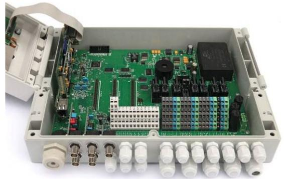
3. Afloje el racor roscado para cables girándolo completamente hacia la izquierda.
